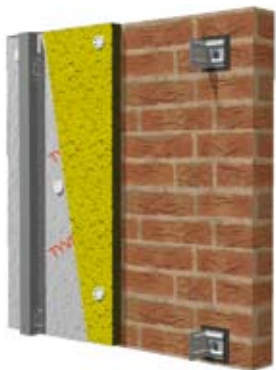
Кронштейны, теплоизоляция, вертикальные профили
